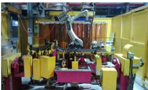
图 3 弧焊机器人电控翻转工作站
