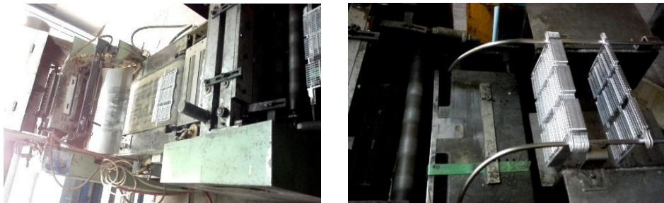
图 2：蓄电池生产-板栅浇铸工艺
