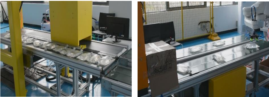
图 5：正在调试的医用液袋自动拣选线系统
