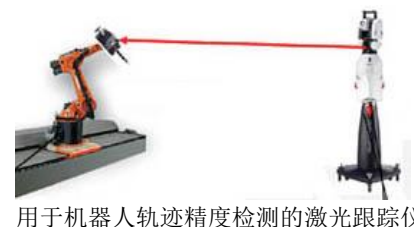
用于机器人轨迹精度检测的激光跟踪仪
