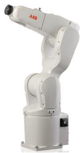
可负载重量 5kg 型的小型处置多关节机器人
