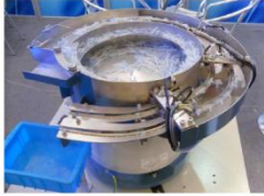
图 1 振动送料装置图
