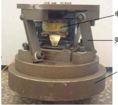
图 2 电磁振动送料器
